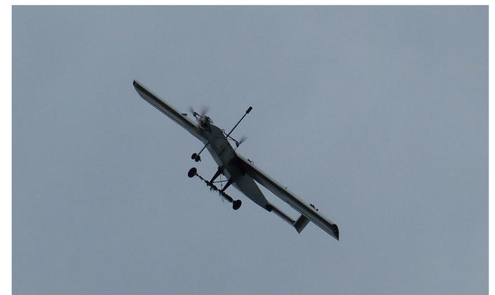
L'avion 4 hybride évolue vers l'avion 5 à aile composite hypersustentée à grand allongement. Cette solution permet de réduire la vitesse minimale de sustentation ( $V_{so}$ ) tout en réduisant la traînée induite par la portance en croisière avec pour effet une diminution du besoin en énergie.
